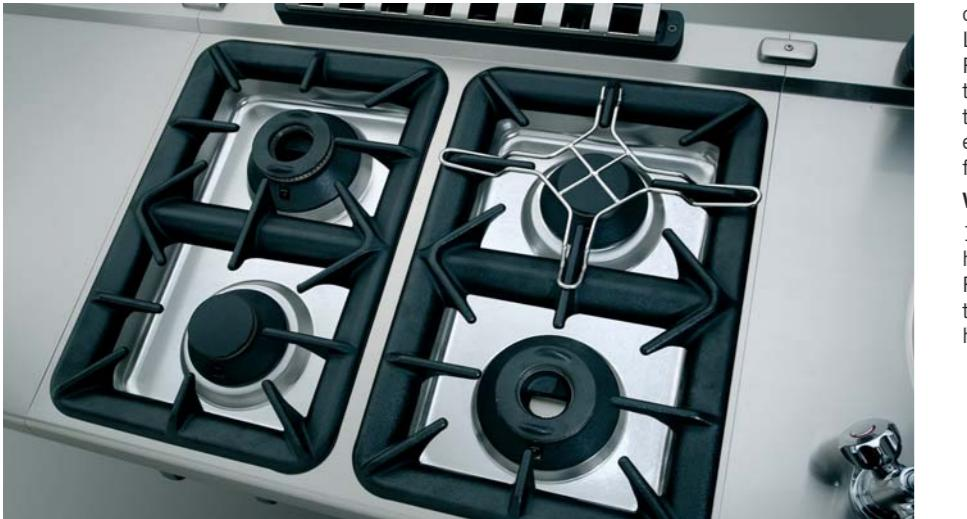
Riscaldamento ottenuto tramite bruciatori a fiamma stabilizzata in ghisa smaltata, a singola e a doppia corona con tre differenti potenzialità (C=3,6 Kw; D=5,5 Kw; E=8 Kw). Griglie di piano in ghisa smaltata opaca posizionate su invaso stampato con bordi raggiati. Vassoi raccoglisughi stampati in acciaio inox 18/10.
